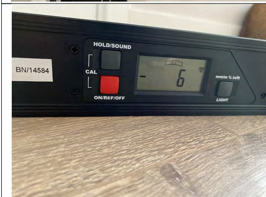
Фото №12. Измерение уровня напольного покрытия в коридоре.
