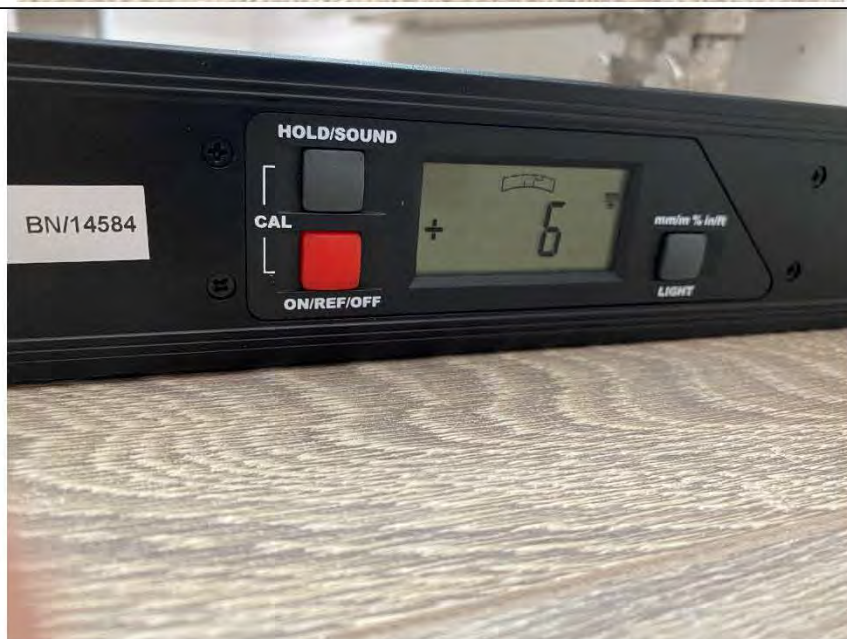
Фото №14. Измерение уровня напольного покрытия в кухне.
